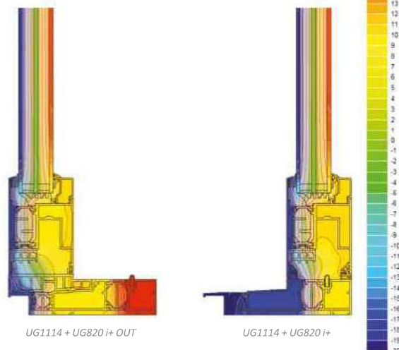
Beispielhafter Isothermverlauf für den Zusammenbau eines Blendrahmens und eines Fensterflügels in UG - Ausführung mit Flachschwelle (UG 114 + UG 820)
