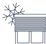
**EXCELLENTE ISOLATION THERMIQUE** – le tablier de volet roulant abaissé en hiver est susceptible de réduire considérablement la perte de chaleur par les fenêtres jusqu'à **26 %**.
