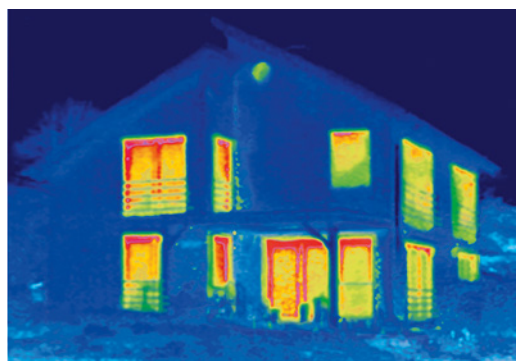
Les images infrarouges ou thermographies révèlent distinctement les zones où une maison perd de l'énergie de manière incontrôlée. Le rouge signifie chaleur et donc forte perte énergétique.
