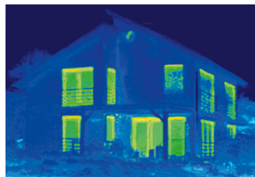
Après l'insertion minutieuse de nouvelles fenêtres issues du système de fenêtres Schüco FocusIng, la thermographie révèle l'efficacité énergétique élevée de l'investissement. La perte énergétique d'origine est presque entièrement éliminée.
