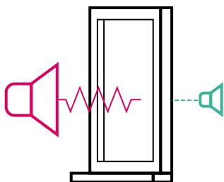
Le finestre REHAU con doppi vetri offrono un eccellente isolamento acustico grazie alle guarnizioni durature e a una costruzione perfettamente ermetica. Con Euro-Design 70, puoi utilizzare vetrocamere fino a 41 mm per un comfort ancora maggiore.
