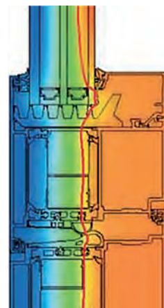
Andamento isotermico Schüco ADS 90.SI
