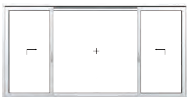
Schemat K 2 skrzydła podnośno-przesuwne, 1 stałe szklenie (fix)
